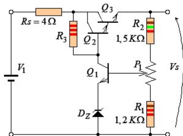
Cálculo de la resistencia de excitación de un transistor de paso de un regulador serie:
