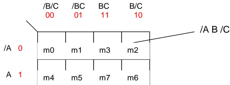
Ejemplo:  $K = \overline{A}BC + A\overline{B}C + A/B/C$
