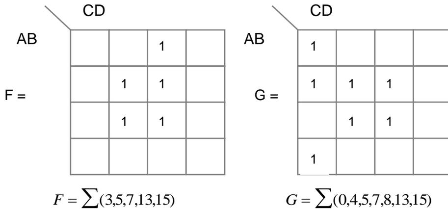
Aquí se puede observar que existen cuatro términos en común permitiendo de esta manera sintetizar sólo una vez la subfunción B D ( que agrupa los mintérminos 5,7,13 y 15) en ambas funciones, con el consecuente ahorro de compuertas.
