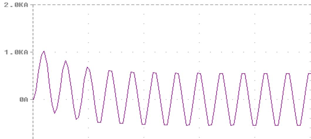
**Corriente Térmica Nominal de Breve Duración,  $I_{th}$**  : **valor eficaz** de la **corriente primaria** que el transformador está en condiciones de soportar **durante 1 segundo**, sin sufrir daños que le impidan su funcionamiento, cuando el **secundario** está **en cortocircuito**.
