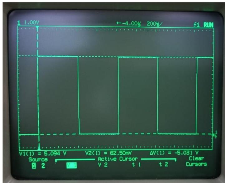
2º) Como segunda etapa, se debe posicionar uno de los cursores en el 10%.  $V(10\%) = 0,1 * 5,031 = 0,5031$  V. En la siguiente fotografía se aprecia que el cursor V2 fue colocado en el valor más cercano al calculado, correspondiente a un  $\Delta V = -500,0$  mV
