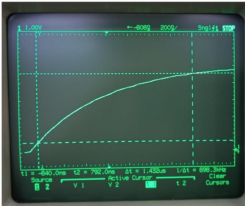
Dado que la pendiente de la onda para el valor 90 % ha disminuido respecto del valor al 10 %, y que se hace más difícil determinar el punto de cruce entre el cursor de tensión al 90 % y la onda, se puede pasar los controles del osciloscopio a vectors off, de manera de ver solo puntos
