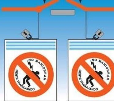
**Bloquear en posición de apertura los aparatos de corte**
